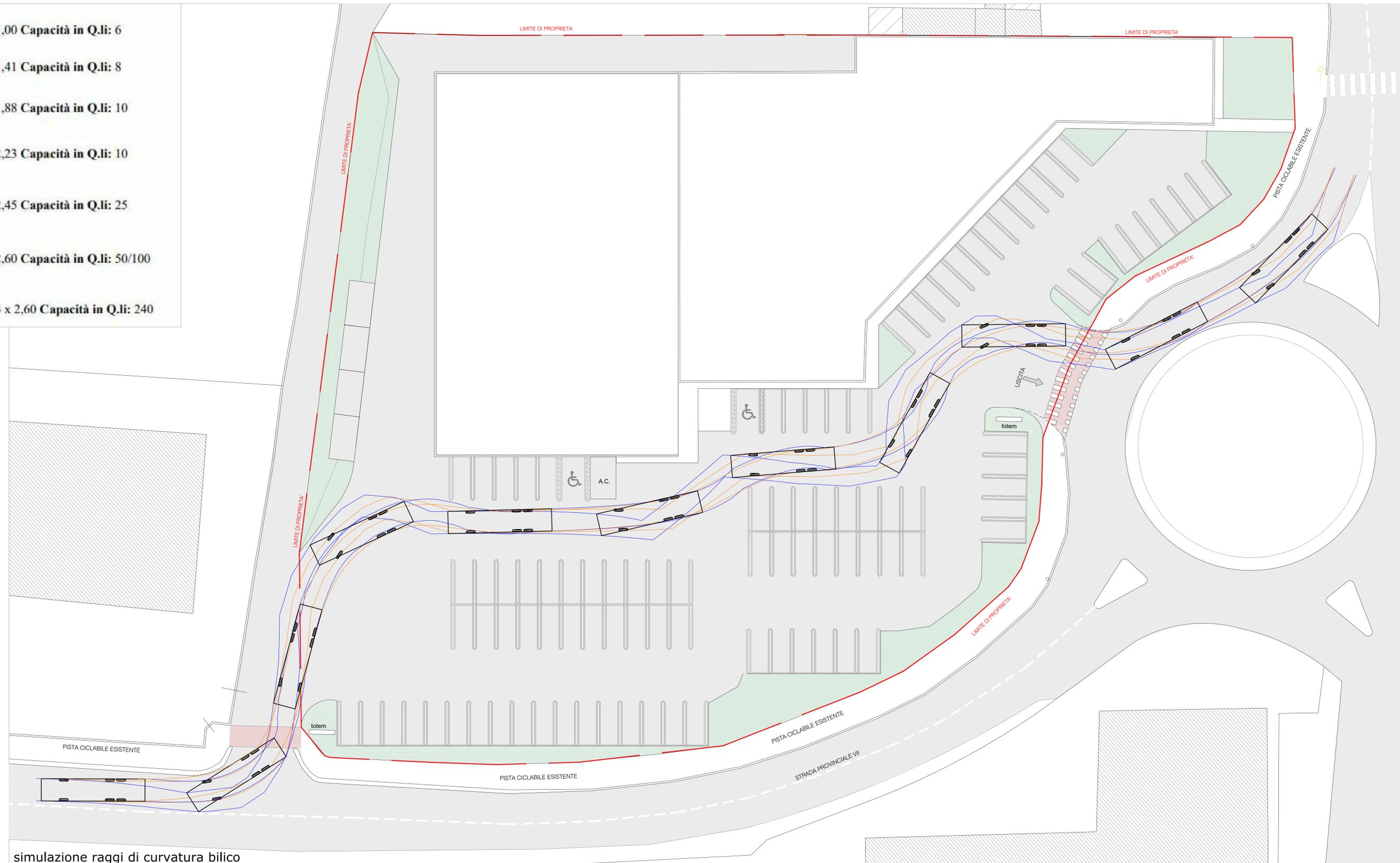
simulazione raggi di curvatura bilico
